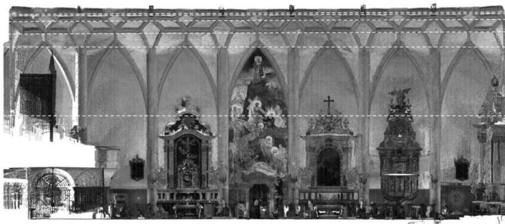
5-6. ábra A szeged-alsóvárosi templom hajóboltozatának hosszszelvénye észak felé a bordacsomópontok pozícióját leíró vonalakkal
