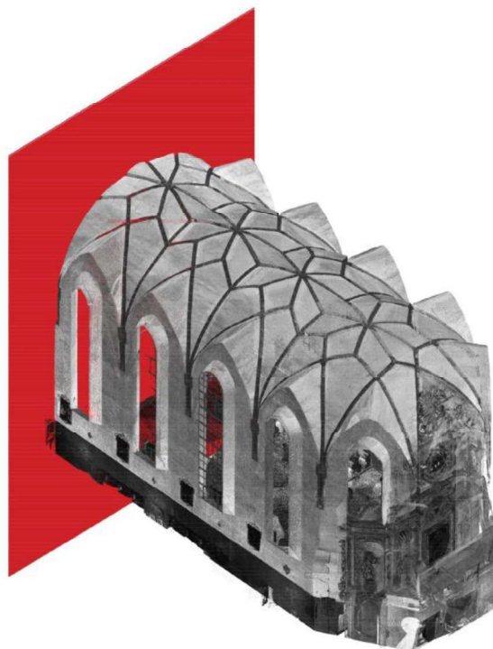
5-23. ábra Az elemzett keresztmetszet irányú vetület helye a szeged-alsóvárosi templom szentélyében
